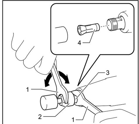
► 1. Wrench 2. Collet nut 3. Spindle 4. Collet cone
