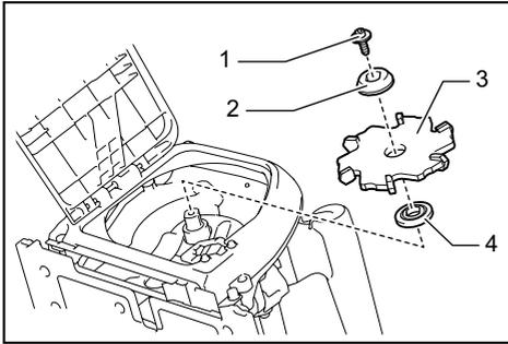
► 1. Hex bolt 2. Outer flange 3. Groove cutter blade
