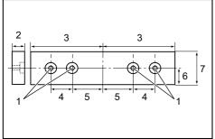
► 1. Hole 2. Over 15 mm 3. Over 270 mm 4. 90 mm 5. 145 mm 6. 19 mm 7. 115 - 120 mm
